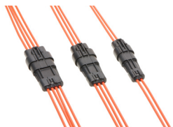
Squba 3.60mmピッチ密封コネクタファミリー、完全嵌合済み、2~4回路、最大電流14.0A
